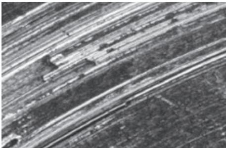
Abb. 8: Riefen und Partikelbildung in Folge Abrasionsverschleiß
